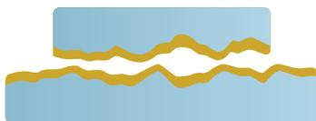
Formación de una capa protectora en las superficies de fricción
