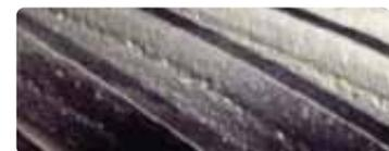
Estado de la superficie después de 7 años de uso de Optigear BM 320. Daños estabilizados. La carga de aceite sigue en su lugar
