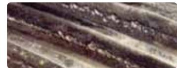
Ejemplo de estabilización de la evolución de las picaduras en el reductor. Condición inicial: picaduras severas/descamación
